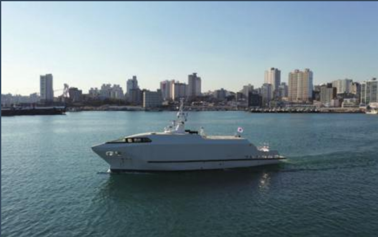
K-조선의 패러다임 전환을 실증하는 자율운항 테스트베드 '해양누리호'. 엔지니어링 자산을 바탕으로 SI 기반의 인지·판단·제어 기술을 통합 실증하며, 대한민국이 자율운항선박 기술의 유리한 고지를 선점하고 있음을 증명하고 있다.
