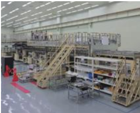
인라인 타입으로 설계된 이 시스템은 대형 기판의 처짐 문제를 해결하는 수평 증착 기술을 적용해 IT용 OLED 생산효율을 극대화했다. 진공 챔버 내에서 유기물을 가열해 RGB 발광층을 형성하는 핵심 공정이 이루어진다.
