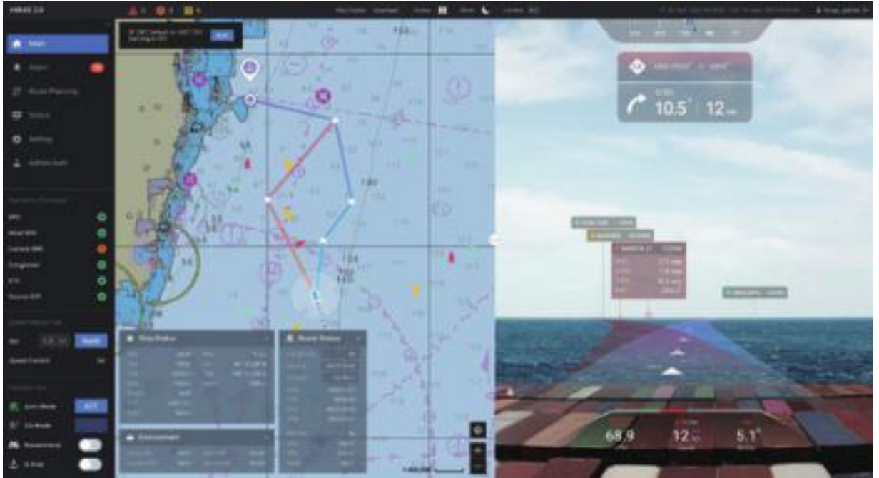
HD현대 아비커스의 지능형 항해 보조 시스템 '하이나스 HINAS '가 탑재된 대형 선박의 모습. 선박에 장착된 카메라와 항해장비를 통해 수집된 주변 상황 정보로 해상교통 안전성을 확보한다.
